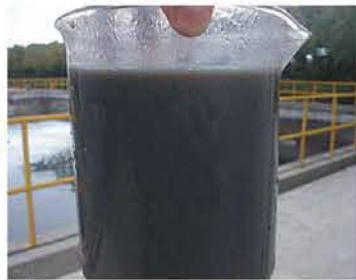
脱水前 Liquid Sludge
